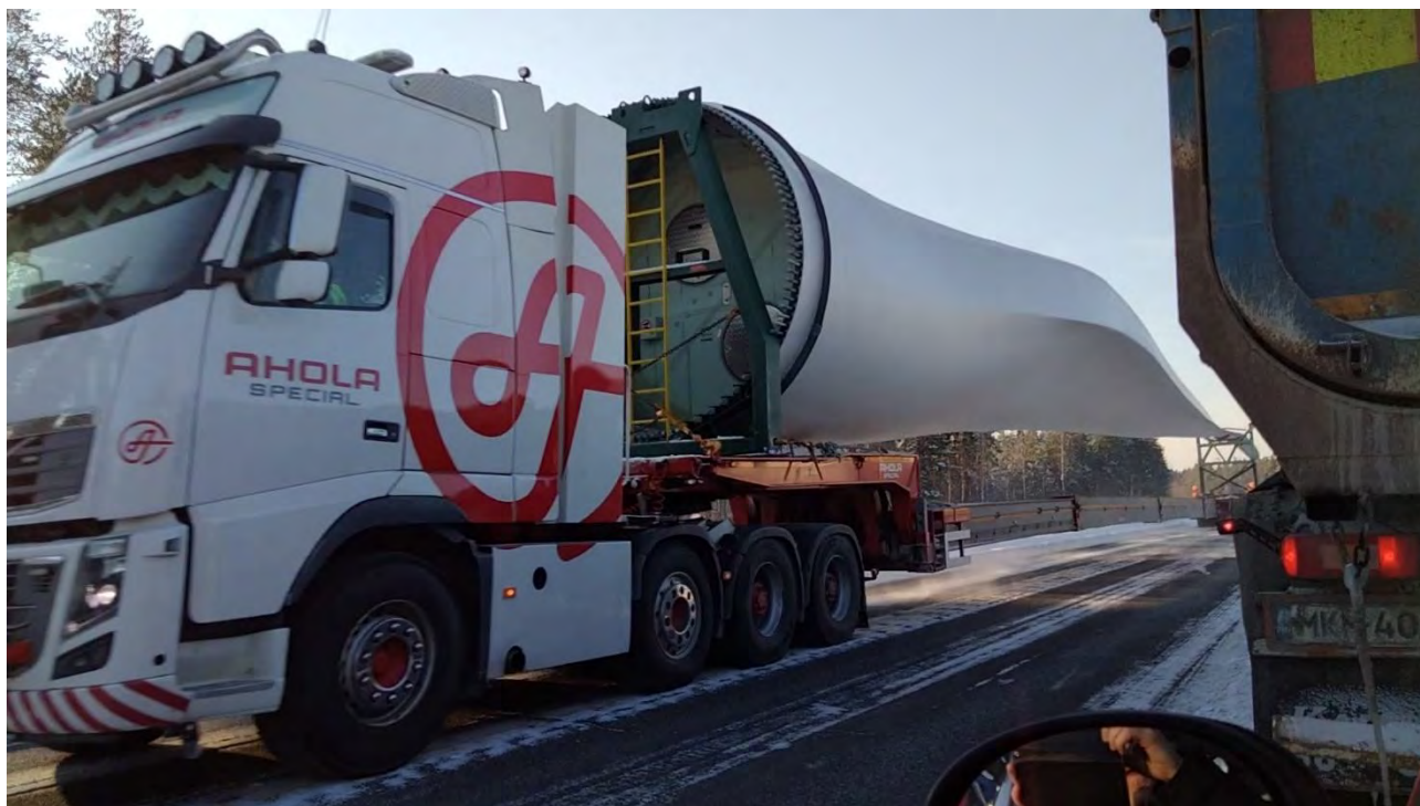
Kuva 6.85 Tuulivoimalan lavan kuljetusta.
