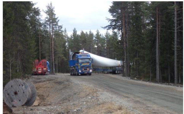
Kuva 94. Vasemmalla: Esimerkki tuulivoimapuiston rakennus- ja huoltotiestä. Maakaapeli sijoitetaan ojakaivantoon tien reuna-alueelle. Oikealla: Tuulivoimalan osia kuljetetaan erikoiskuljetuksina. (Kuvat: FCG).
