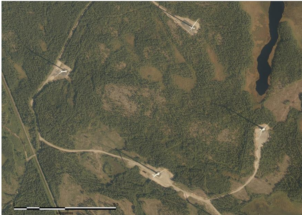
Kuva 88. Esimerkkikuva toiminnassa olevasta tuulivoimapuistosta. Tuulivoimaloita varten on rakennettu huoltotiet ja nostokentät. Tuulivoimaloiden ympäristössä ja välialueilla aikaisempi maankäyttö on säilynyt ennallaan.
